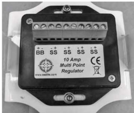
Use la etiqueta para asegurar la correcta ubicación de los cables durante el montaje
