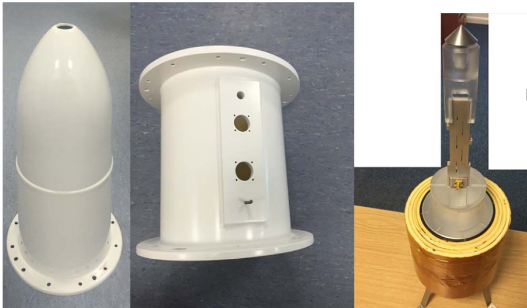
Racon Phalcon-NT, Detalle del Ensamble de Antenas y la Carcaza Superior e Inferior
